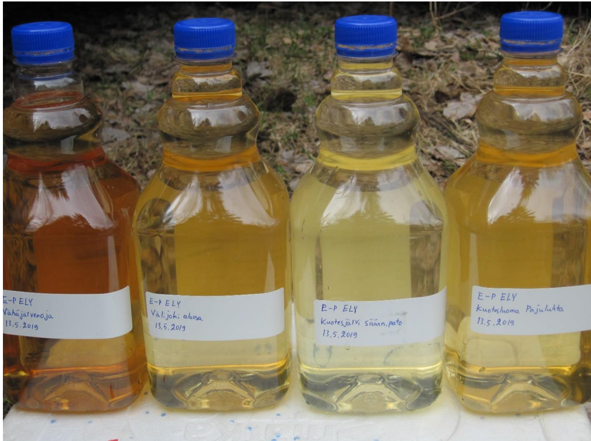
Kuva 15. Vedenpinnan noston jälkeen keväällä 2019 vesi oli tummintaa hankealueen yläpuolella Vähäjärvenojassa ja vähiten tummaa Kuotesjärven padolla.
